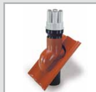
MSD 110 z siedmioma króćcami i sześcioma rurami termokurczliwymi Jeden króciec jest w momencie dostawy zamknięty, w razie potrzeby może zostać otwarty. Odpowiedni do maksymalnie czterech kabli o średnicy 7 - 23 mm i maksymalnie trzech kabli o średnicy 7 - 30 mm. Dostępne akcesoria: głowiczki AK lub korki zaślepiające VS 25 i VS 32 MSD 110-D7/32/25
