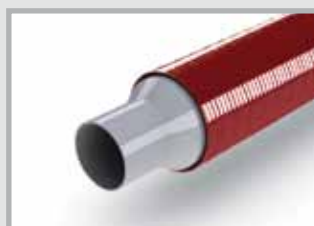
Pokrywa systemowa D1 Z jednym króćcem do uszczelnienia kabli w technice kurczliwej. D1-110: króciec Ø 110 mm do kabla Ø 34 - 108 mm. Dostępna dla KSS B150. D1-80: króciec Ø 80 mm do kabla Ø 26 - 78 mm. Dostępna dla KSS B150. D1-75: króciec Ø 75 mm do kabla Ø 26 - 73 mm. Dostępna dla KSS B90.
