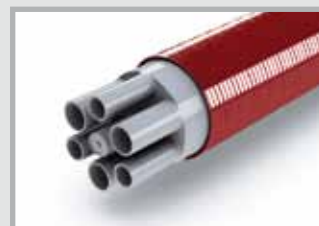
Pokrywa systemowa D7 Z siedzioma króćcami do uszczelnienia do siedmiu kabli w technice kurczliwej. D7-32-25: trzy króćce Ø 32 mm do kabli Ø 12 - 30 mm; cztery króćce Ø 25 mm do kabli Ø 7 - 23 mm. Dostępna dla KSS B150.
