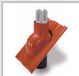
MSD 85 z pięcioma króćcami i pięcioma rurami termokurczliwymi Odpowiedni do pięciu kabli o średnicy 7 - 18 mm. Dostępne akcesoria: głowiczki AK lub korki zaślepiające VS 20. MSD 85-D5/20
