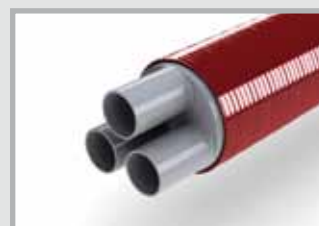
Pokrywa systemowa D3 Z trzema króćcami do uszczelnienia do trzech kabli w technice kurczliwej. D3-46: króćce Ø 46 mm do kabli Ø 16 - 44 mm. Dostępna dla KSS B150. D3-30: króćce Ø 30 mm do kabli Ø 7 - 28 mm. Dostępna dla KSS B90.
