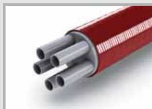
Pokrywa systemowa D5 Z pięcioma króćcami do uszczelnienia do pięciu kabli w technice kurczliwej. D5-20: króćce Ø 20 mm do kabli Ø 7 - 18 mm. Dostępna dla KSS B90.
