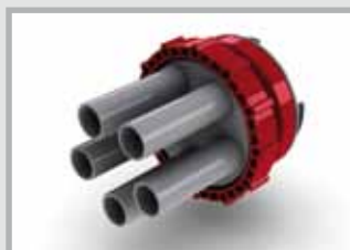
Pokrywa systemowa z pięcioma króćcami i pięcioma rurami termokurczliwymi Odpowiednia do pięciu kabli o średnicy 7-18 mm. Jako akcesoria są dostępne głowiczki AK lub korki zamykające VS 20.
