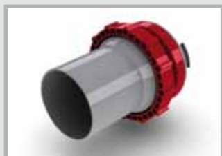
Pokrywa systemowa z jednym króćcem i rurą termokurczliwą Wykonanie do kabla o średnicy 26-73 mm.
