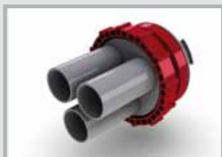
Pokrywa systemowa z trzema króćcami i trzema rurami termokurczliwymi Odpowiednia do trzech kabli o średnicy 7-28 mm. Jako akcesoria są dostępne głowiczki AK lub korki zamykające VS 30.
